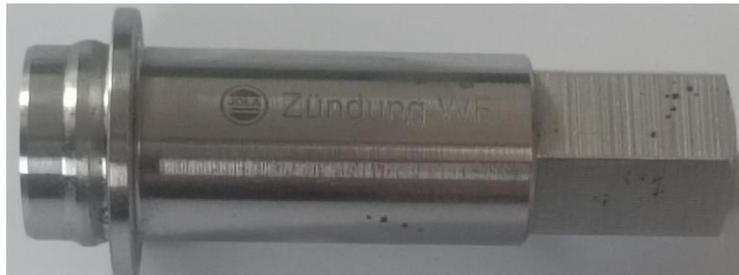
2. Zugspindel für Kurbelwelle (Kupplungsseite) / Pull spindle for crankshaft (clutch side)
