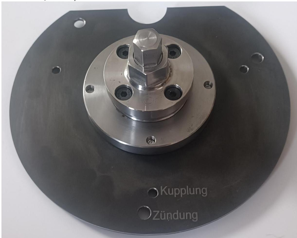
Montage der Zündungsseite / Assembly of the ignition side
